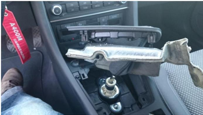
4. Una vez levantado, ya podemos acceder a los tornillos(2) para así poderlos aflojar y desmontar la pieza.
