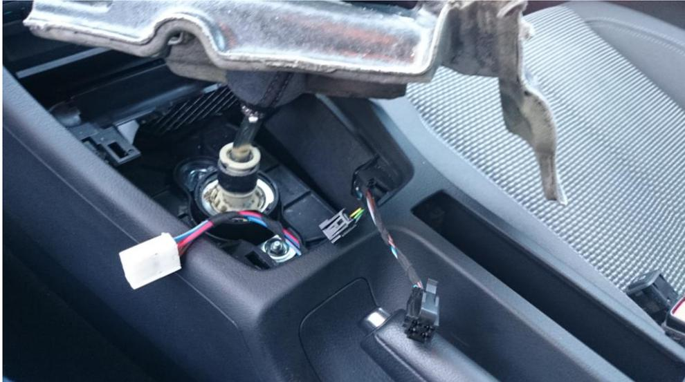
7. Como ya tenemos suelta la pieza del mechero, por fin podemos cambiar el portalámparas fundido.
