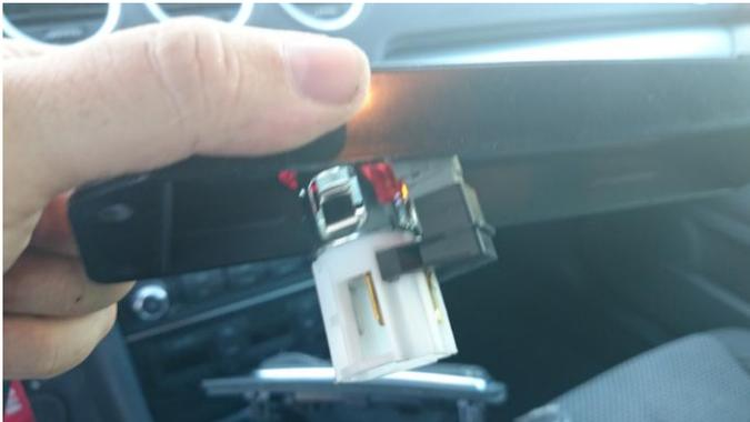
Aquí ya podéis ver el portalámparas. Primero hay que desmontar la pieza negra y después el portalámparas (que es la pieza gris). Ambas se quitan, utilizando un destornillador para hacer palanca con suavidad para no romperlo y tirando de ella hacia atrás.
